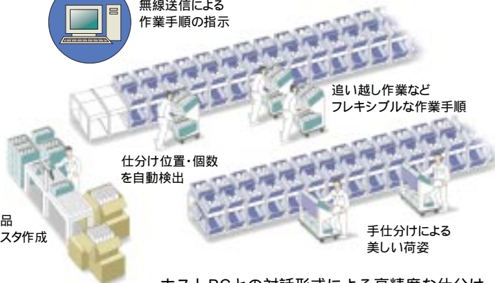
ホストPCとの対話形式による高精度な仕分け 通過型物流センター
